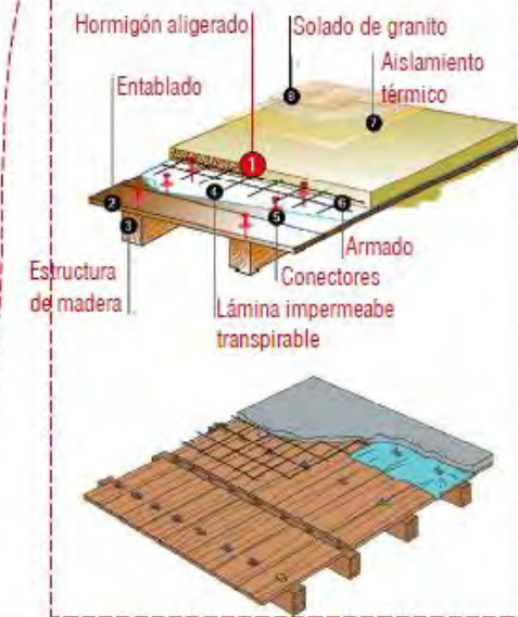
Detalle constructivo del nuevo forjado propuesto
